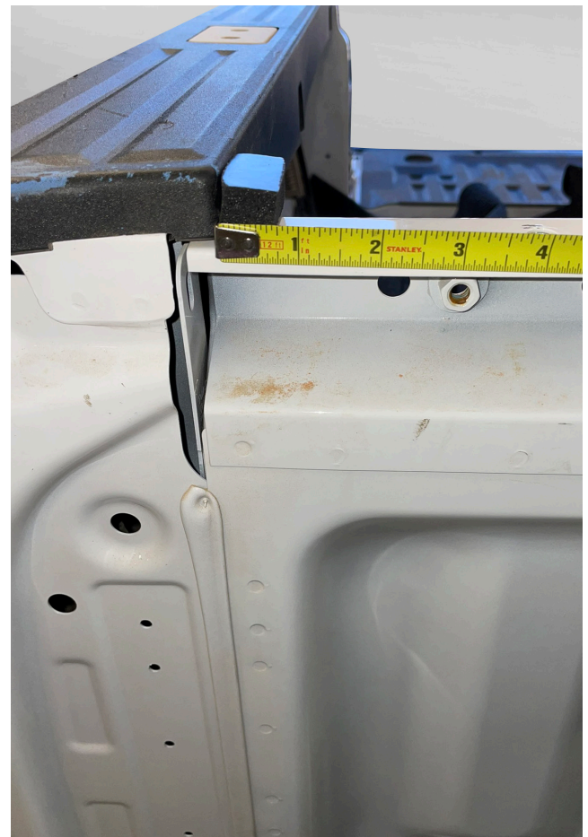
10. Corte un pedazo de cinta selladora de espuma de 1" y colóquelo en el mamparo contra el riel superior. Repita del otro lado.
