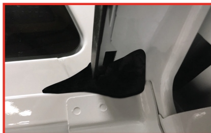
Presser le morceau et colmater le passage entre le protège-rebord et le rail avant.
