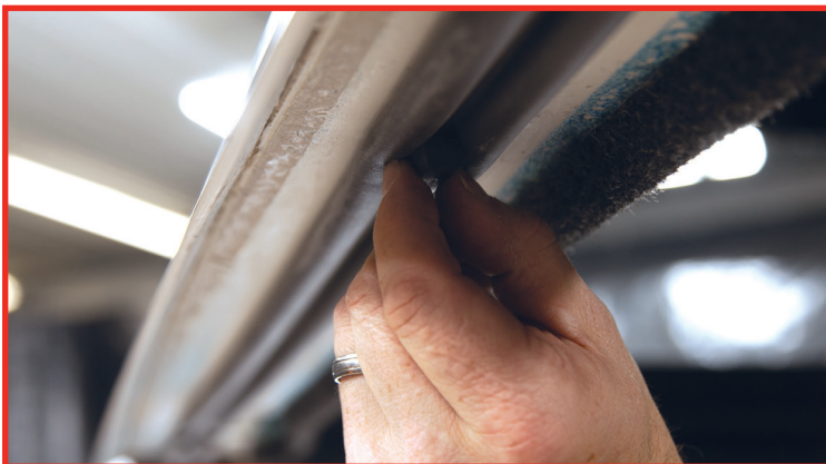
Enlever les (4) entretoises logées dans le joint à bulbe, sous le rebord de la boîte.
