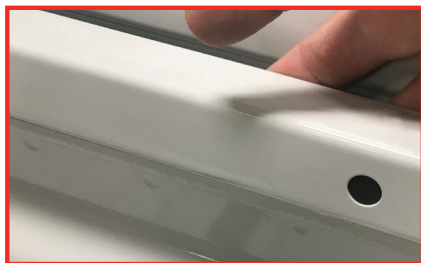
Nettoyer le rebord de caisse avant et les protège-rebords.
