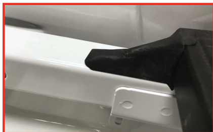
Presser le morceau et colmater le passage entre le protège-rebord et le rail avant.
