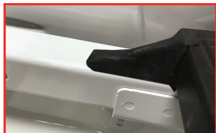
Compacte cinta de butilo/masilla y cree una transición desde el protector del platón al riel frontal.
