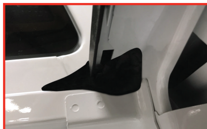
Compacte cinta de butilo/masilla y cree una transición desde el protector del platón al riel frontal.
