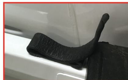
Doble cinta de butilo/masilla en tercios, aproximadamente a 2" del protector del platón.
