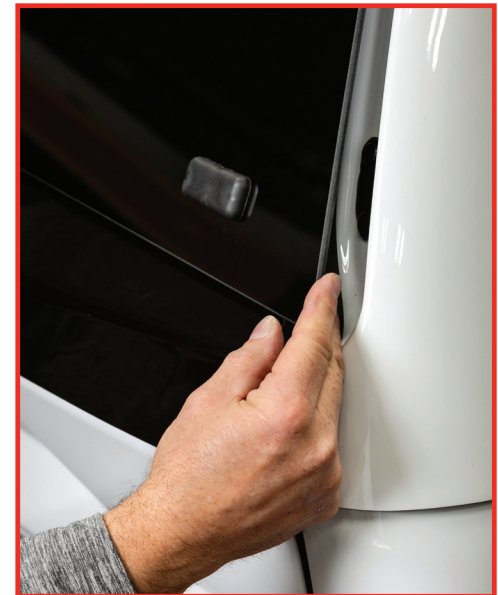
Fig B. Vérifier l'alignement et le jeu de la porte, des poignées et des joints.
