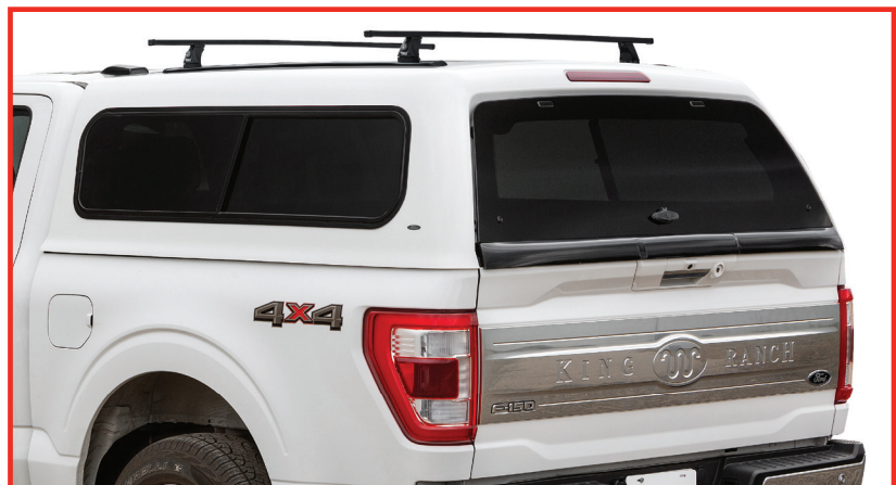
Rectifier au besoin pour bien aligner la boîte sur la camionnette.
