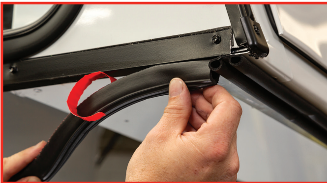
Figura B. Aplique el sello del mamparo en la parte inferior delantera de la tapa, haciendo tope con el sello del bulbo doble del lado del conductor y del pasajero.
