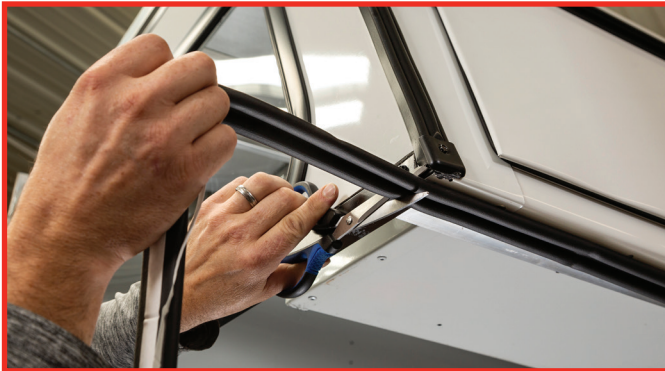
Figura A. Comenzando en la parte trasera del lado del conductor, aplique el sello de bulbo doble a 5/8" desde el borde exterior de la tapa en línea recta hacia el frente.
