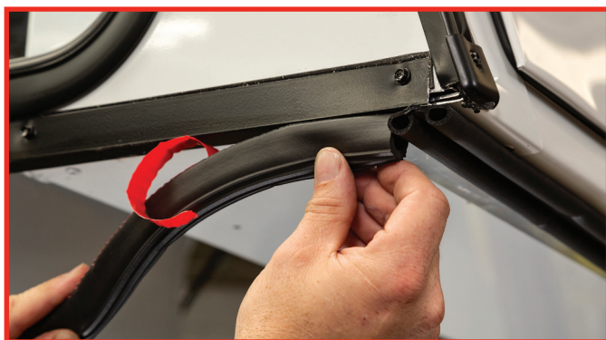
Fig. B. Appliquer le joint de cloison sous le bord avant de la boîte, au ras des joint doubles de bulbe, côtés conducteur et passager.
